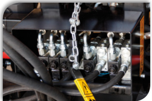
System zaworów elektromagnetycznych (opcjonalnie).
