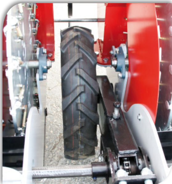
Koła napędzające z 15 calową regulacją wysokości.
