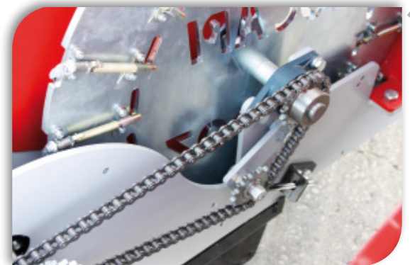
Zmiana gęstości liniowego nasadzenia przez korektę koła łańcuchowego.
