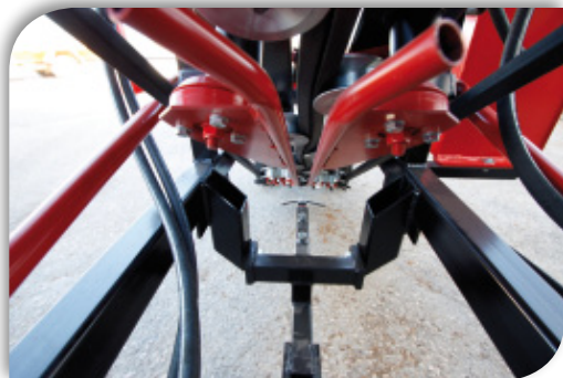
System wibracji - za pomocą 2 równoległych wibratorów obrotowych.
