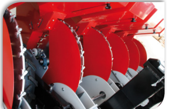
Główny wał napędowy o 32 mm średnicy do przekazania napędu na poszczególne rzędy.
